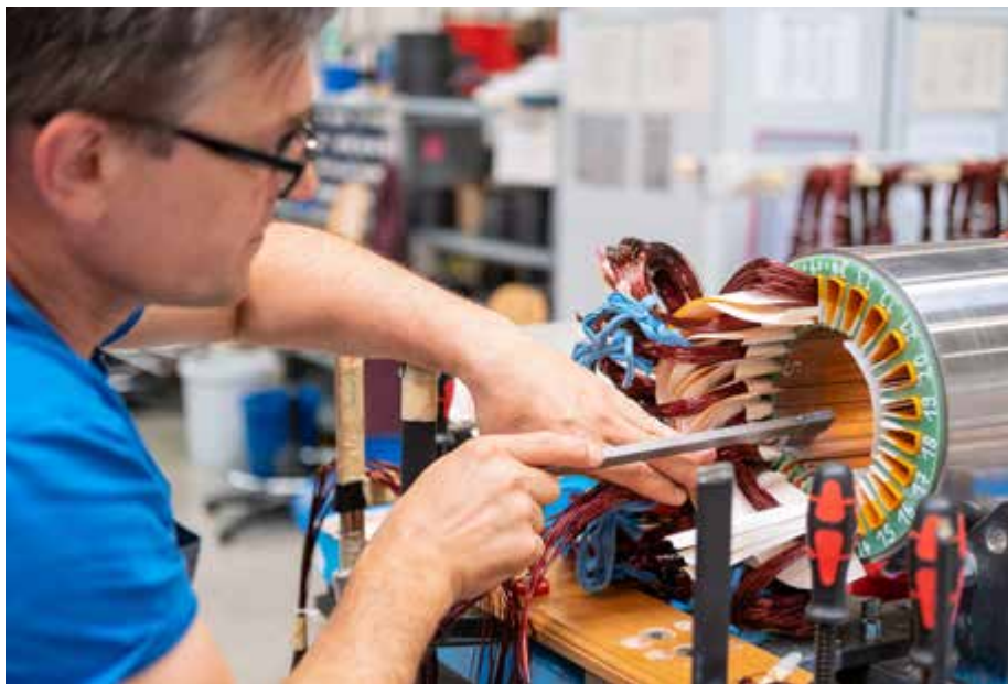
Volodymyr Timtschischin, Mitarbeiter der Wickelei, beim Bewickeln eines Stators
